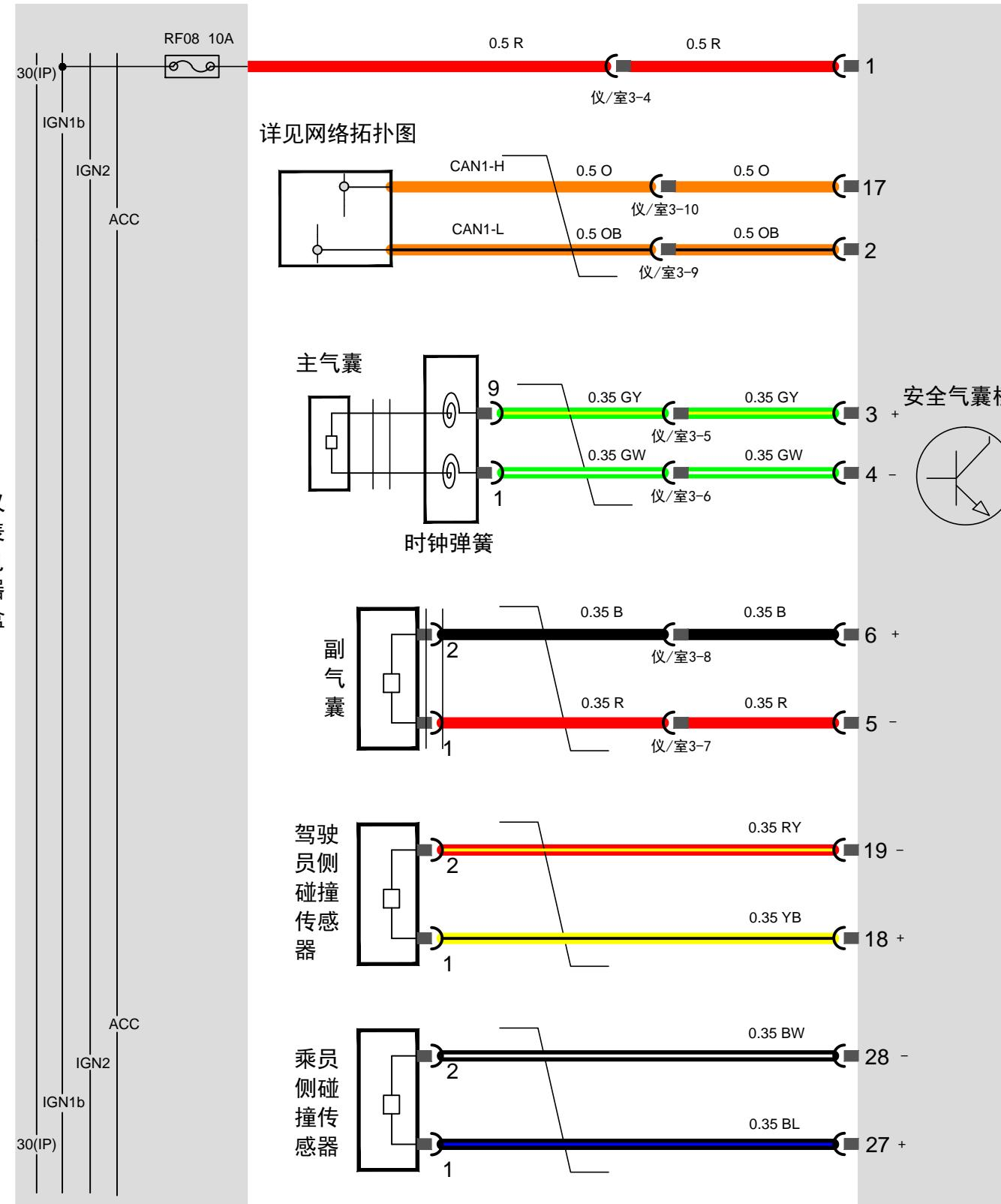
注：电路图中 符号为短路片，插件插好后，短路片与插件端子断开。
